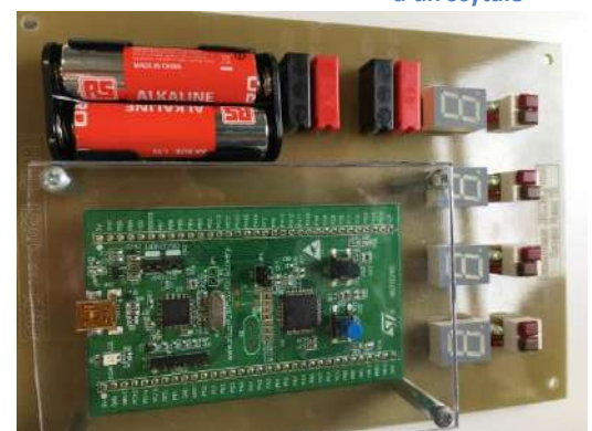
Figure 2 : Visuel du circuit électrique
