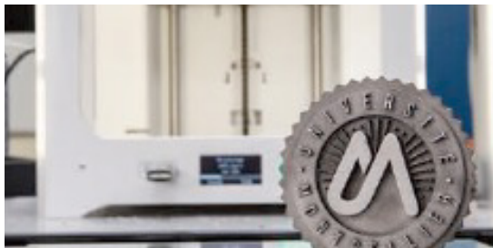
En arrière plan, une imprimante 3D de type FDL à dépôt de fil thermoplastique ; au premier plan le logo de l'Université de Montpellier, pièce massive imprimée en acier inoxydable. (Crédit photo, © Christophe Argoues, /LMGC/CNRS photothèque)
